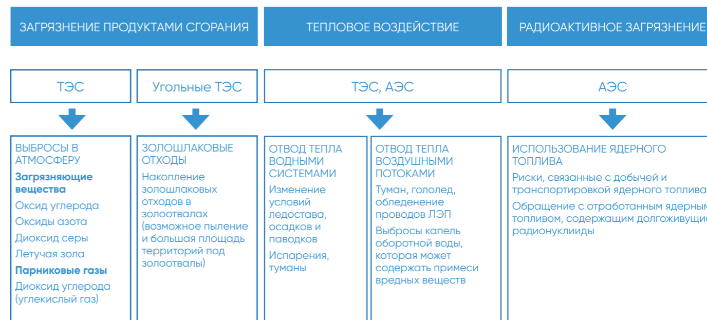
Рис. 21. Основные факторы воздействия на окружающую среду при производстве электроэнергии из ископаемого топлива
